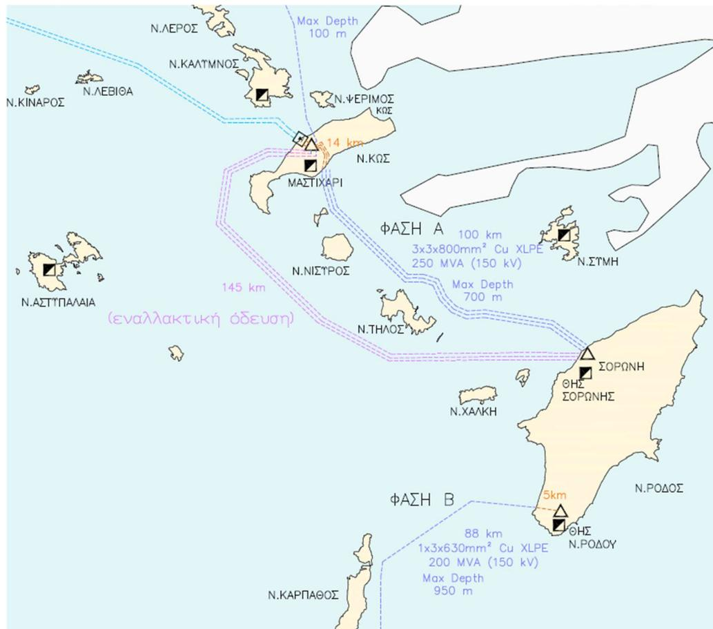
Σχήμα 22: Εναλλακτικές οδεύσεις υποβρύχιων καλωδίων διασύνδεσης Κω – Ρόδου
