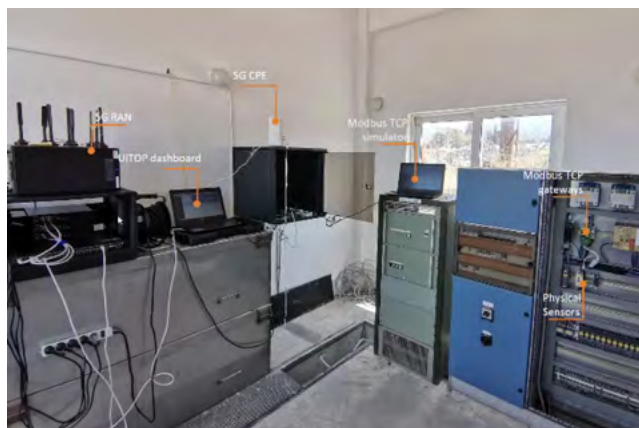
Εικόνα 29 Στιγμιότυπο της πλατφόρμας συλλογής δεδομένων (αριστερά). Εξοπλισμός για την υποστήριξη 5G δικτύου και υπολογισμών στην εγκατάσταση του ΑΔΜΗΕ
