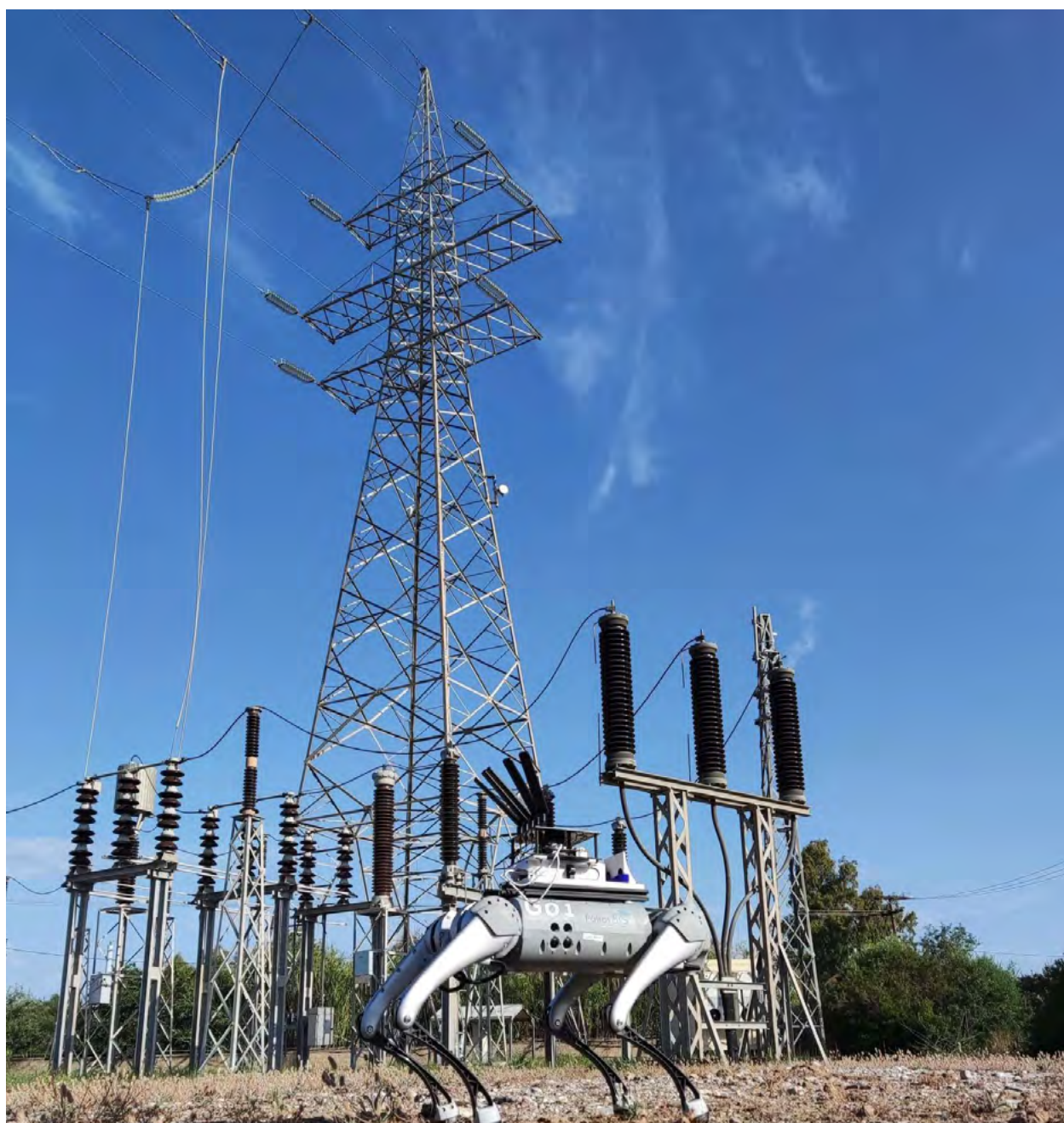
Εικόνα 30 Επίδειξη ρομπότ με σύστημα καμερών για την επίβλεψη της εγκατάστασης
