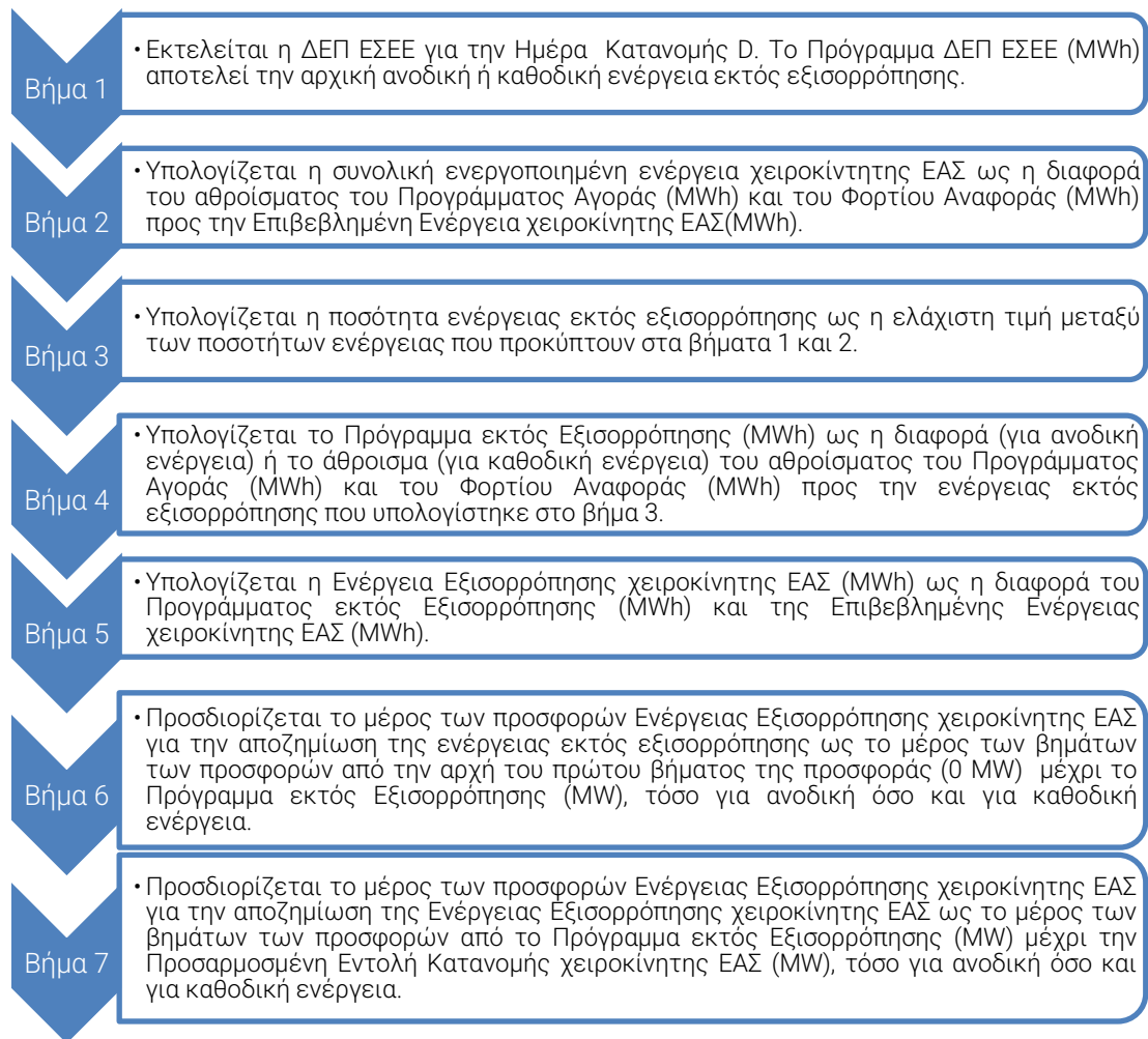
Σχήμα 9 Διάκριση Διαδικασία υπολογισμού της ενέργειας εκτός εξισορρόπησης για τα Χαρτοφυλάκια Κατανεμόμενου Φορτίου
